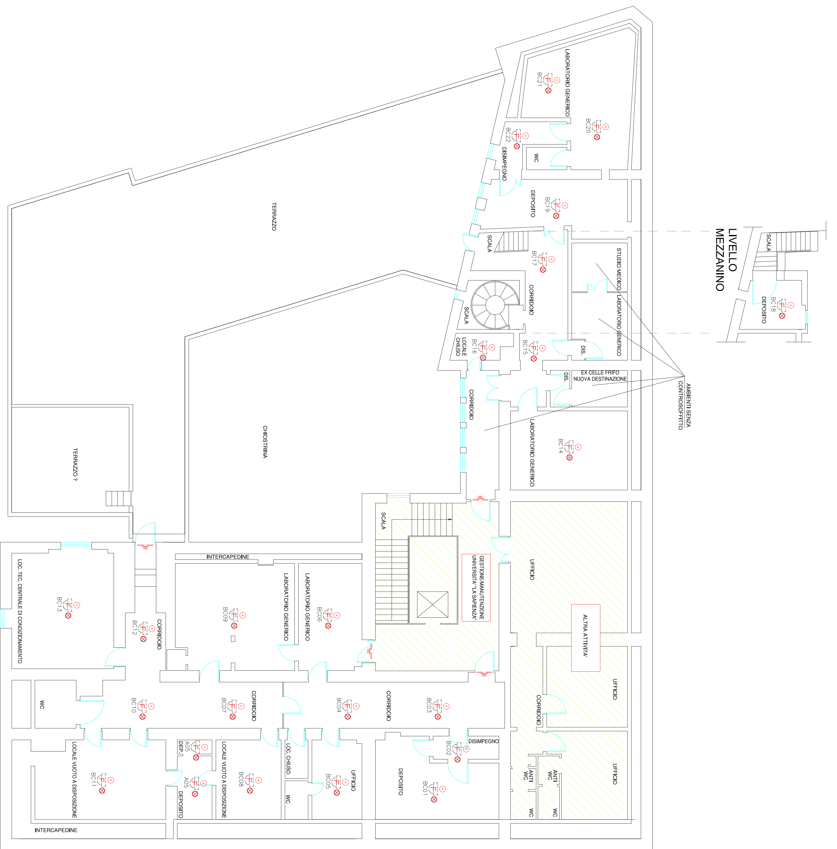
IMPIANTO DENTRO IL CONTROSOFFITTO - LOOP B
